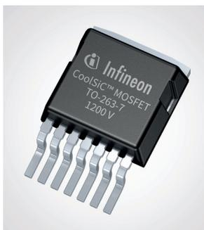
Die neuen CoolSiC MOSFET-Leistungshalbleiter mit .XT-Verbindungstechnologie in einem 1200-V-optimierten D-2PAK-7 SMD-Gehäuse der Infineon Technologies AG erlauben eine passive Kühlung und können bei wartungsfreien Invertern für Motoren eingesetzt werden. Das reduziert die Verluste um bis zu 80 Prozent im Vergleich zu einer Lösung auf Siliziumbasis und
