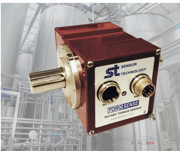
Althen Sensors & Controls führt neue berührungslose Drehmomentsensoren im Programm. Die Messtechnik basiert auf einer DMS-Vollbrücke und überträgt die Messsignale mit der Erkennung von akustischen Oberflächenwellen. Die TorqSense SGR510/520-Sensoren
