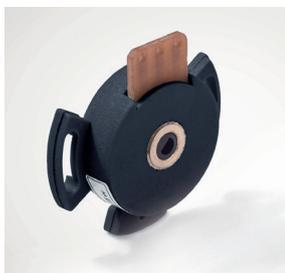
Die Hohlwellen-Leitplastikpotentiometer der Serie MHP16 von Megatron finden auch in sehr engen Bauräumen Platz. Das Gehäuse der Komponente hat einen Durchmesser von 16,4 und eine Tiefe von 6 mm, der Wellendurchmesser beträgt 2 mm. Die Leitplastikpotentiometer bieten einen elektrisch wirksamen
