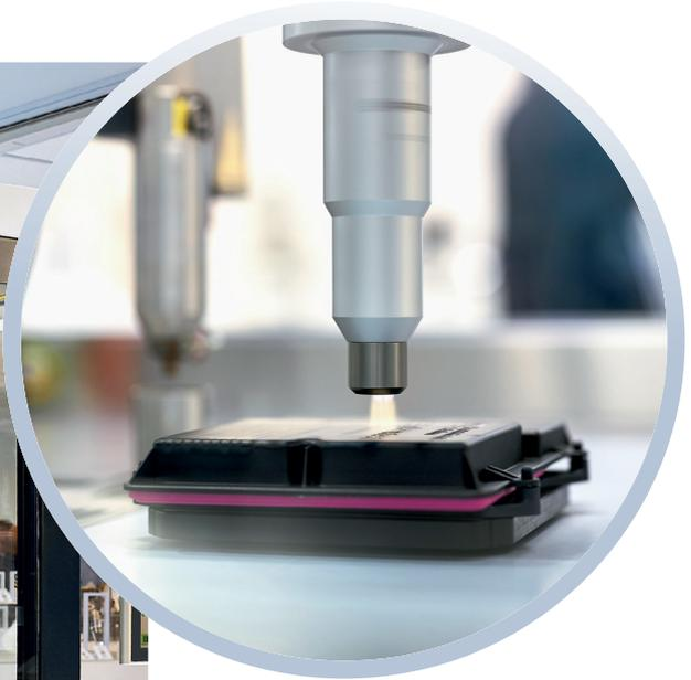
Die Plasmamatreat GmbH hat eine Plasma Treatment Unit vorgestellt, die Werkstücke präzise und flexibel mit dem Planarmotorsystem Xplanar von Beckhoff transportieren kann. Dieser ersetzt das Bewegen der oft empfindlichen Werkstücke zum Beispiel PCBs sowie den aufwendigen Einbau von 6-Achs-Robotern bzw. Linearmotoren.
